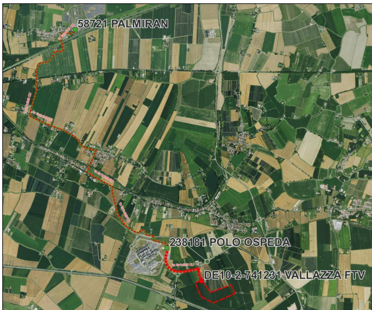
Fig. 3b. Inquadramento del progetto Impianto Fotovoltaico e Opere Connesse-Cona. L'elettrodotto interrato da realizzarsi è compreso tra le cabine Vallazza FTC e Polo Ospedale, mentre quello esistente è compreso tra le cabine Polo Ospeda e Palmiran
